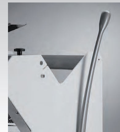
■ Levier à traction progressive
